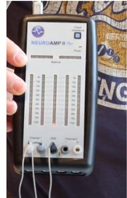
Der Grund für das Aufleuchten der einzelnen roten LED ist, dass die Impedanz von einer, zwei oder drei (allen) Elektroden über dem Maximalwert liegt, der über 100.000 Ohm beträgt. Wenn die Impedanz der Elektroden diesen Grenzwert überschreitet, kann das Impedanzmessgerät nicht richtig funktionieren. Der Grund für schlechte Impedanzen kann sein, dass der Kontakt der Elektrode zur Haut nicht gut genug ist. Es könnte auch sein, dass eine oder mehrere der Elektroden kaputt sind.
